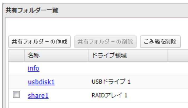
USBドライブを取り外すときは、必ず取り外し処理を行ってください。取り外し処理を行わずにUSBドライブを取り外すと、もう一度接続した際に、正常に認識できないことがあります。このようなときは、本製品を再起動してから接続してください。
