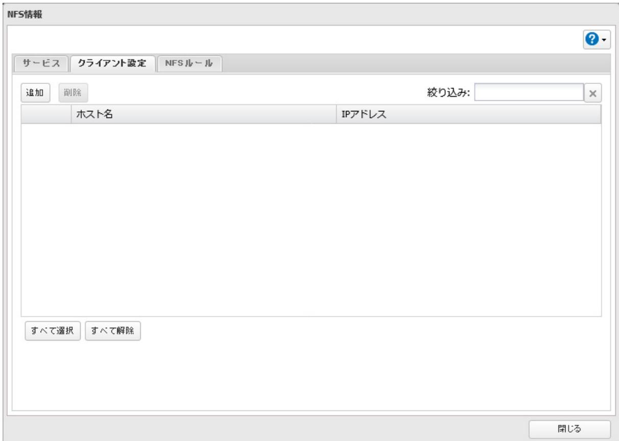
10 NFSクライアント (UNIX系OSなど)のIPアドレスとホスト名を入力し、[OK]をクリックします。
